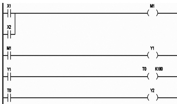
图2 水冷保护装置的PLC控制程序
